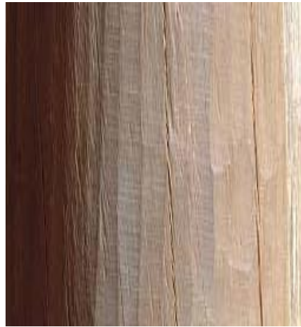
Figura 3. Grano desviado en la madera. Figura 4. Grano desviado (En espiral).
