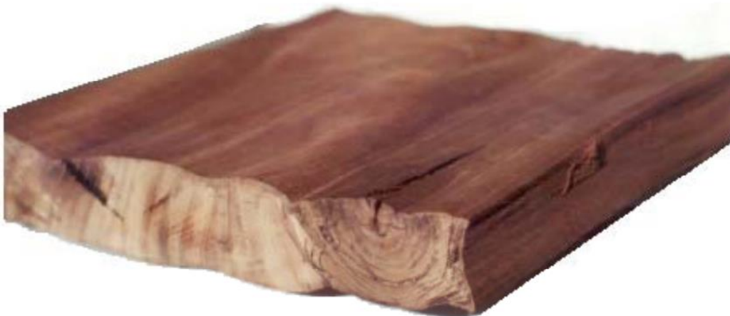
Ejemplo de agrietamiento interno y colapso en madera de Cedro (Cedrela sp.)
