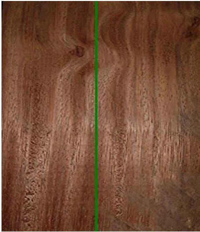
Figura 3. Grano desviado en la madera. Figura 4. Grano desviado (En espiral).
