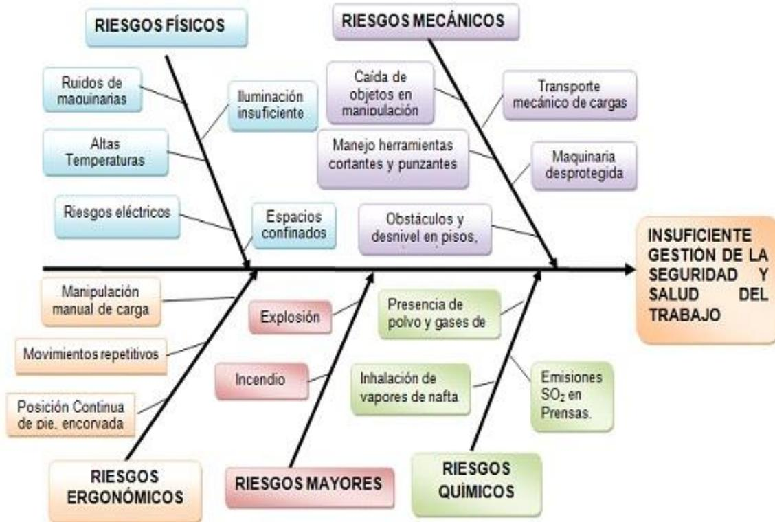
**Figura 2.** Diagrama Causa – Efecto: Insuficiente Gestión del Sistema de Seguridad y Salud del Trabajo.
