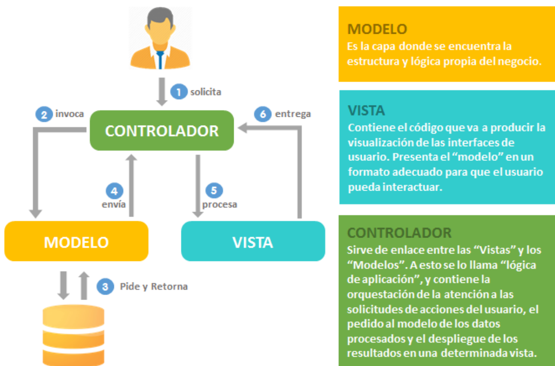
Figura 3: Representación del patrón de arquitectura Modelo-Vista-Controlador
